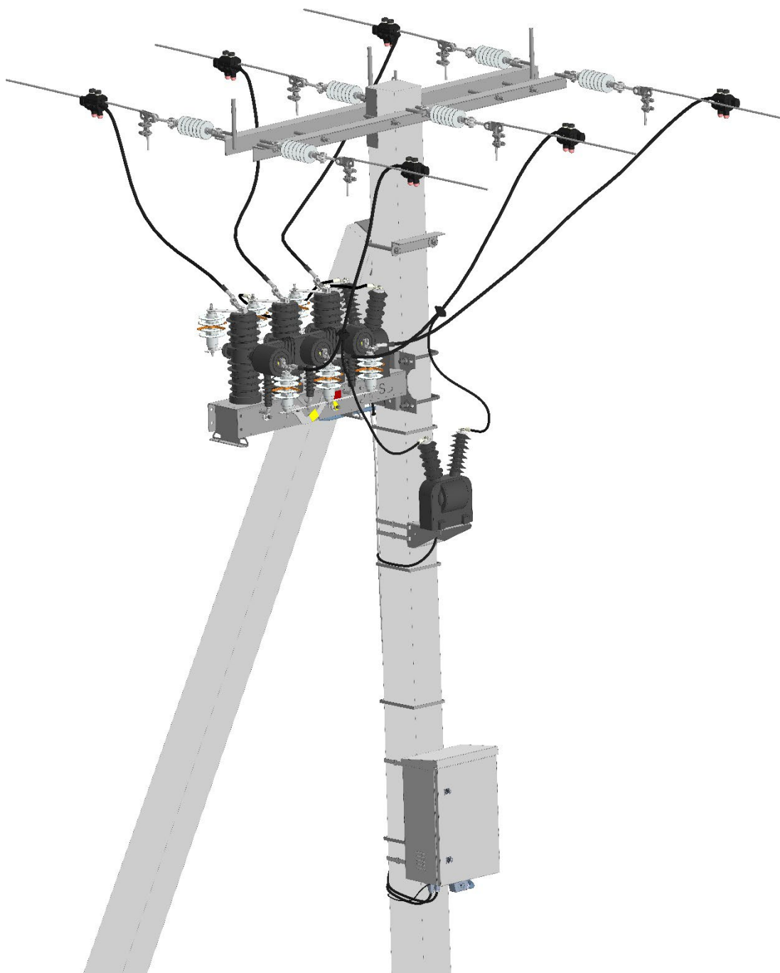
Рис. 5.1.1 Приклад розміщення реклоузера AR12pro на анкерній опорі
